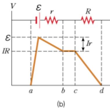
그림 (b)는 회로에서 시계 방향으로 진행하며 측정한 전위의 변화를 나타낸 것이다. 따라서, 기전력  $E$ 는 다음과 같이 표현된다.
