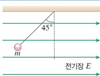
그림은 균일한 전기장에서 질량  $m$  인 대전체가 실에 매달려 정지해 있는 모습을 나타낸 것이다. 실은 연직 방향과  $45^\circ$  를 이루며, 전기장의 세기는  $E$  이고 방향은 중력에 수직하다. 대전체의 전하량은? (단, 중력 가속도는  $g$  이고, 실의 질량은 무시한다.)
