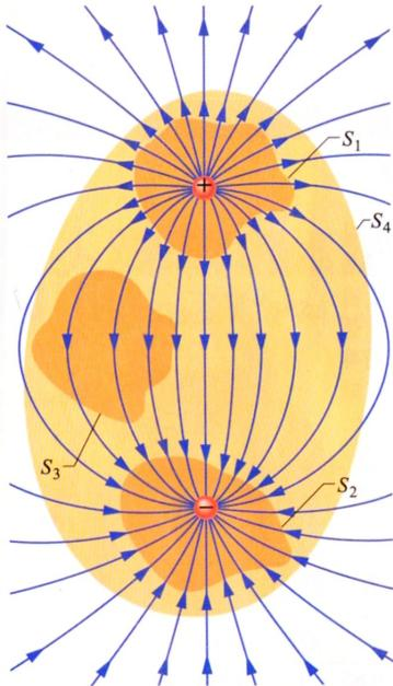
그림은 크기는  $q$  로 같고 부호가 반대인 두 전하와 이들이 주위 공간에 만든 전기력선을 나타낸 것이다. 이때  $S_1$  ,  $S_2$  ,  $S_3$  ,  $S_4$  는 모두 가우스면이다. 가우스 법칙에 따라 각각의 가우스면을 기준으로 전기선속은? (단, 공간의 유전율은  $\epsilon$  이다.)
