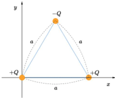
그림은 전하량이 각각  $+Q$ ,  $+Q$ ,  $-Q$  인 점전하를  $xy$  평면에서 같은 간격  $a$  로 놓아 고정한 것을 나타낸 것이다. 계의 전기 퍼텐셜 에너지는? (단, 공간의 유전율은  $\epsilon$  이다.)
