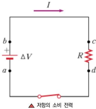
점  $a$  로부터 시계 방향으로 양전하  $Q$  가 전지와 저항기를 통해 이동하여 점  $a$  로 되돌아온다. 전하가  $a$  에서  $b$  로 움직일 때 전기적 퍼텐셜 에너지는  $Q\Delta V$  만큼 증가하고, 전지 내 화학 에너지는 같은 양만큼 감소한다. 전하가  $c$  에서  $d$  로 저항을 통해 이동할 때 저항 내의 원자들과 전자들이 충돌하는 동안 에너지는 소모된다. 전하  $Q$  가 저항을 통과할 때 전기적 위치 에너지를 잃는 비율은 다음과 같다.
