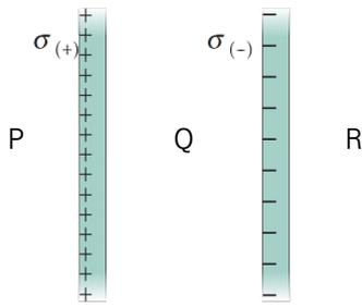
그림은 균일한 면 전하밀도  $+\sigma$ ,  $-\sigma$ 의 평행하게 마주보는 무한 평면을 나타낸 것이다.
